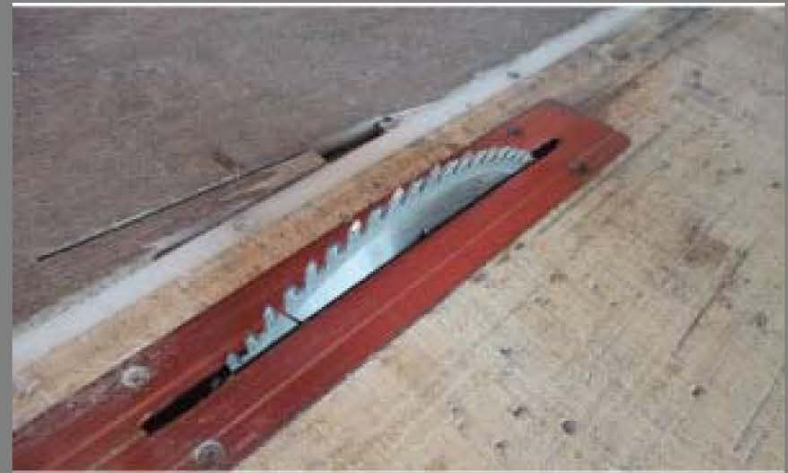
简约木工锯：锯片相对密集，圆锯切割机，金钢石锯片2毫米。
